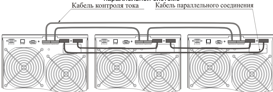
Рисунок 27 – Подключение информационных кабелей к трем ИБП в параллельной системе
