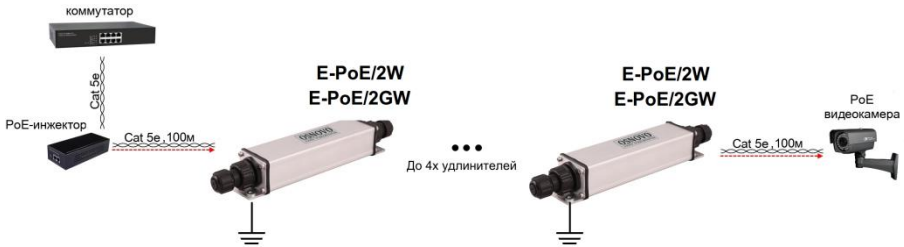
Рис. 3 Схема подключения удлинителей E-PoE/2W, E-PoE/2GW
