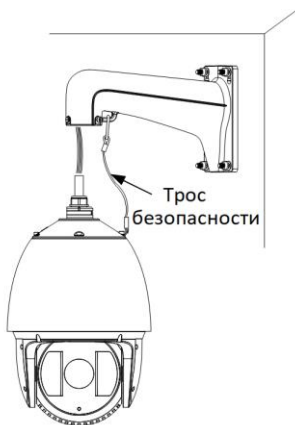
Рисунок 2-19 Установка троса безопасности
